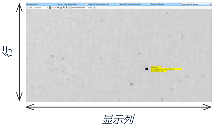
图 12 - 软件使用合成图像来定位显示器中的缺陷像素，该合成图像将来自成像系统采集的显示器的多个高分辨率测量图像的数据进行了组合。
