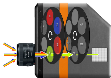
图 5 - 与CIE匹配的三色刺激滤光轮系统（这里显示在ProMetric® I系列成像色度计内）使测量设备能够从人眼感知的角度采集亮度值和色度值。
